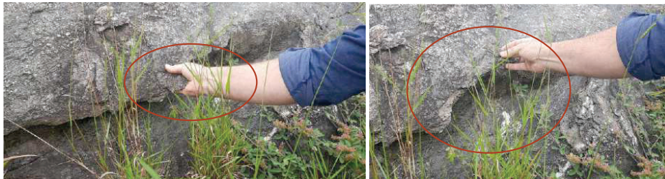
Figura 10: Talude 01 - Afloramento muito frágil.
